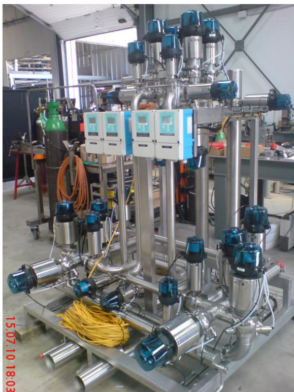
Le manifold filtration et contrôle
